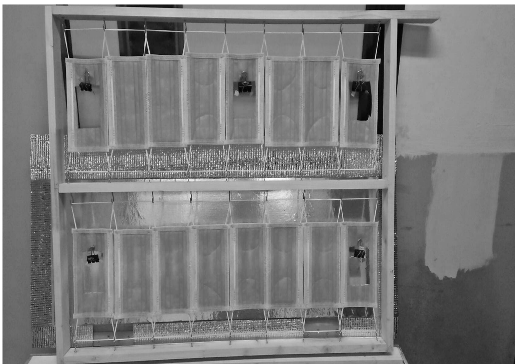
ภาพที่ 2 หน้ากากอนามัยที่ทำกรเจาะเป็นช่องไว้สำหรับหนีบชิ้นส่วนหน้ากากที่ทำกรหยดเชื้อทดสอบ (ปกด้านใน)
